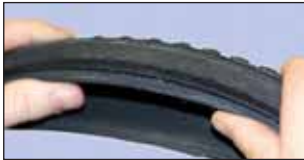
Fissures de vieillissement.
