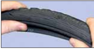
Fissures de fatigue.
